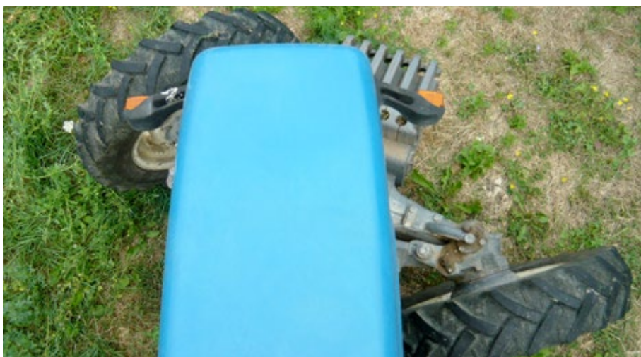
Obr. 3: Natáčení kol přední nápravy – systém SuperSteer
